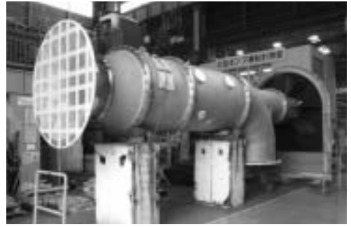
Fig. 5 コンバインドサイクル向け循環水ポンプ (三菱)
