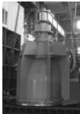
Fig. 2 二相ステンレス鋼板製立軸斜流ポンプ(クボタ)
