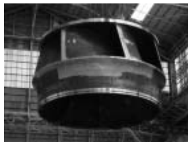
Fig. 9 Lewiston発電所 水車ランナ
