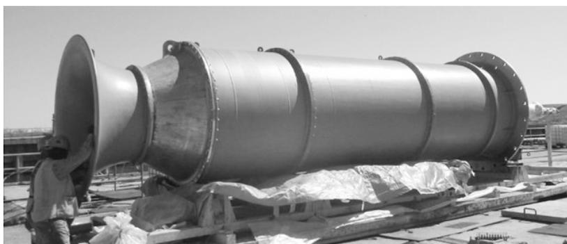
Fig. 3 火力発電所向けプルアウト式循環水ポンプ（三菱重工業）
