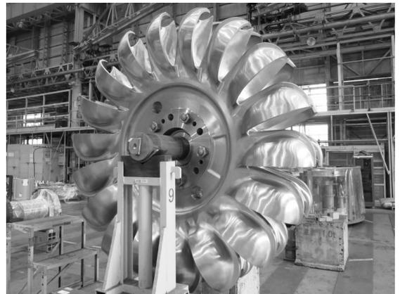
Fig. 7 称名川第二発電所 立軸ペルトン水車ランナ
