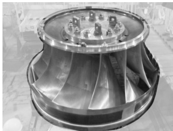
Fig. 5 早明浦発電所 立軸フランシス水車ランナ
