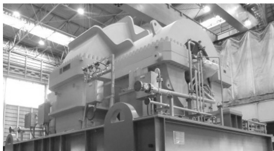
Fig. 6 PDHプラント用遠心圧縮機 (荏原エリオット)
