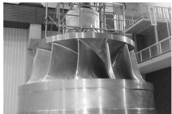
Fig. 4 水殿発電所 立軸フランシス水車ランナ
