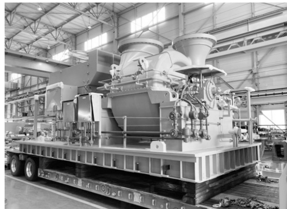
Fig. 7 海外向けエアブロー1,900 kW (電業社機械)
