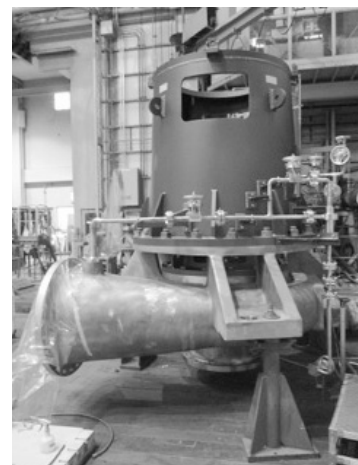
Fig. 2 ヒンクリーポイントC原子力発電所向け立型単段渦巻ポンプ（三菱重工業）
